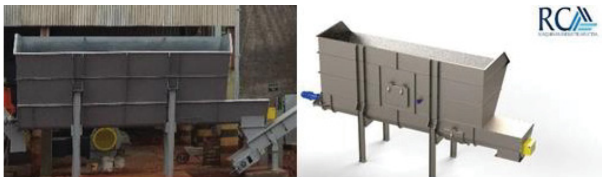
FIGURA 12 – Moega dosadora transportadora
