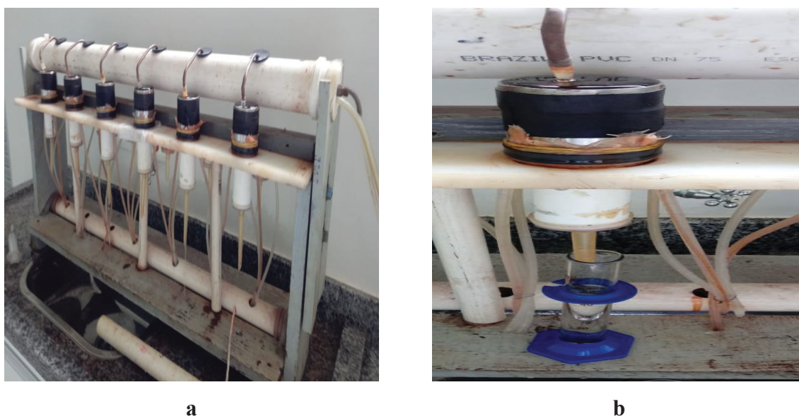
Figura 4. Permeômetro de carga constante (a). Amostra com estrutura preservada com carga constante de 2 cm de água e proveta para coleta do volume percolado (b).
