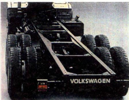
**Plataforma de carga:** chassi robusto com longarinas retas, reforços tipo "U" e travessas especiais, garante ao veículo grande resistência no trabalho árduo, nas operações fora de estrada, não apresentando fadiga mesmo sob forte processo de torção e flexão a que é submetido quando opera na palhada, para um PBT de 21.400 Kg ou carga de 15.086 kg.
