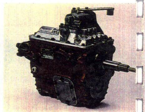
**Caixa de Câmbio:** o sistema de transmissão, com embreagem tipo diafragma especial, é formado pela caixa de câmbio CL 450, de 5 marchas, do tipo engrenagem constante, e pela caixa de transferência com comando pneumático de grande relação de redução, que permite trabalhar em baixa velocidade sem sobrecarga do sistema e ser queimar o disco de embreagem.
