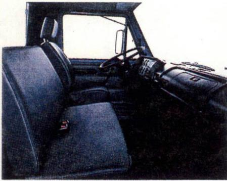
**Conforto:** a isolamento termoacústica da cabina mantém o motorista distante do ruído e do calor. O Sistema de ventilação forçada, com filtragem que renova o ar continuamente, independentemente da velocidade do veículo, é elétrico, com duas velocidades, combinado com oito difusores de ar no painel de instrumentos e portas. Banco do motorista individual, com apoio de cabeça, de múltiplas regulagens, permite fácil acesso aos comandos.
