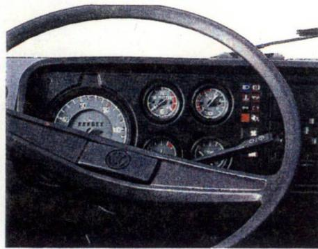
**Painel de instrumentos:** painel de instrumentos completo, com sistema tríplice de alerta (sonoro, luz indicadora e instrumento de medição) para: temperatura da água, pressão do óleo do motor e pressão do sistema de freios. E sistema duplo (sonoro, luz indicadora) para: nível de água do radiador e alarme de trava da cabina.
