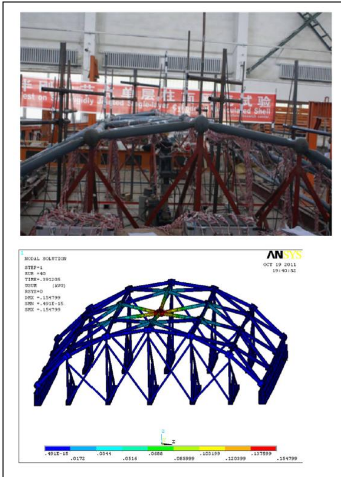
Fig. 9. Modelo experimental e o modelo computacional (via ANSYS) [38].
