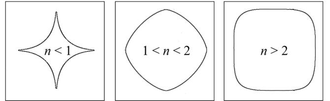
Fig. 2. Célula quadrada com fibra de seção transversal superelíptica para  $a = b$  e  $n < 1$ ,  $1 < n < 2$  e  $n > 2$ .
