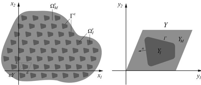
Fig. 1. Seção transversal de um compósito bifásico periódico formado por uma matriz contendo fibras paralelas idênticas de seção transversal arbitrária.
