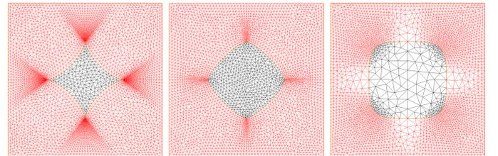
Fig. 3. Discretização por elementos finitos da célula básica com fibra de seção transversal superelíptica com  $a = b = 0.5$  e  $n = 0.7$ ,  $n = 1.3$  e  $n = 4$ .
