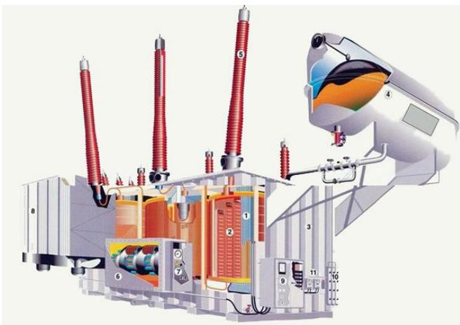
Fig. 3. Componentes de um Transformador de Potência. Fonte: Lorencini Brasil, Catálogo T.P.R.D., 1999
