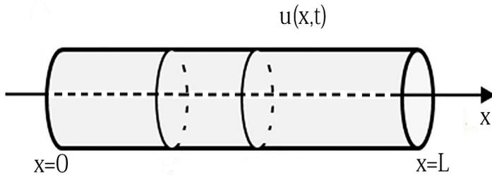
Figura 1: Condução de calor em um barra homogênea finita.
