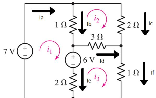
Figura 2. Convenção das correntes a serem encontradas pelos diferentes métodos.
