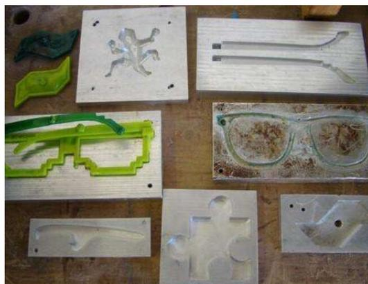
**Figura 4:** Moldes feitos na fresadora CNC (Oficina Ecolab/Mudalab).
