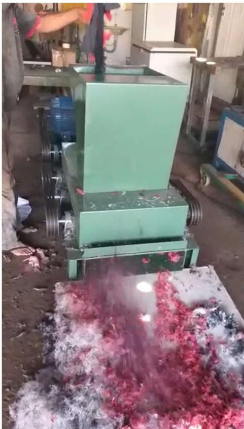
**Figura 11:** A fragmentadora de tecidos em operação, sem a carenagem para visualização do motor, polias e correias.
