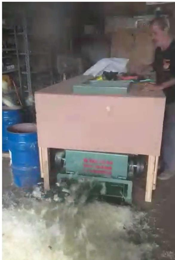
**Figura 12:** A fragmentadora de tecidos em operação, com a carenagem de proteção. FONTE: Elaborado pelos autores(2021).
