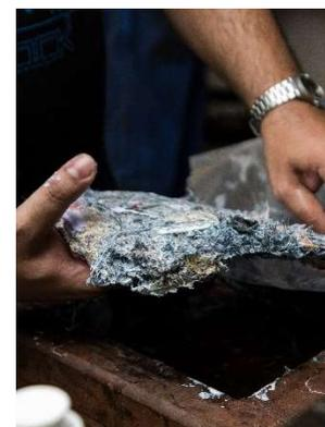
**Figura 5:** Placa de tecido fragmentado obtida por meio de prensagem. FONTE: Ingrid Gonçalves (2020).
