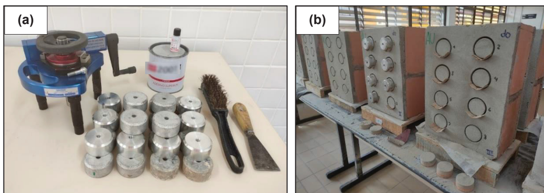
FIGURA 41 – Preparo dos prismas para ensaio de aderência: equipamentos, utensílios e materiais utilizados na realização do ensaio (a); pastilhas metálicas coladas sobre as áreas delimitadas (b)
