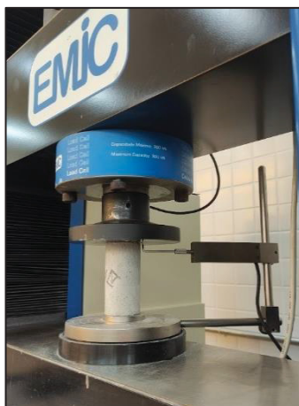
FIGURA 23 – Execução do ensaio de módulo de elasticidade estático
