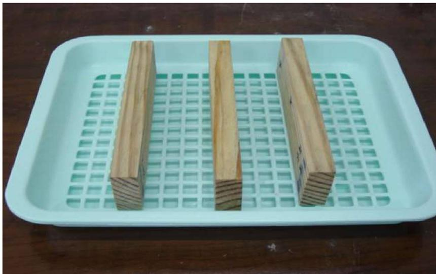
Após a aplicação da imersão em óleo frio, as amostras foram colocadas em recipiente para o escorrimento do óleo superficial. No término deste período, foram pesadas (Massa 1). Após 24 horas do final da aplicação do tratamento foram medidas a largura, a espessura, o comprimento e massa de cada amostra (Medidas Tratadas e Massa 2).
