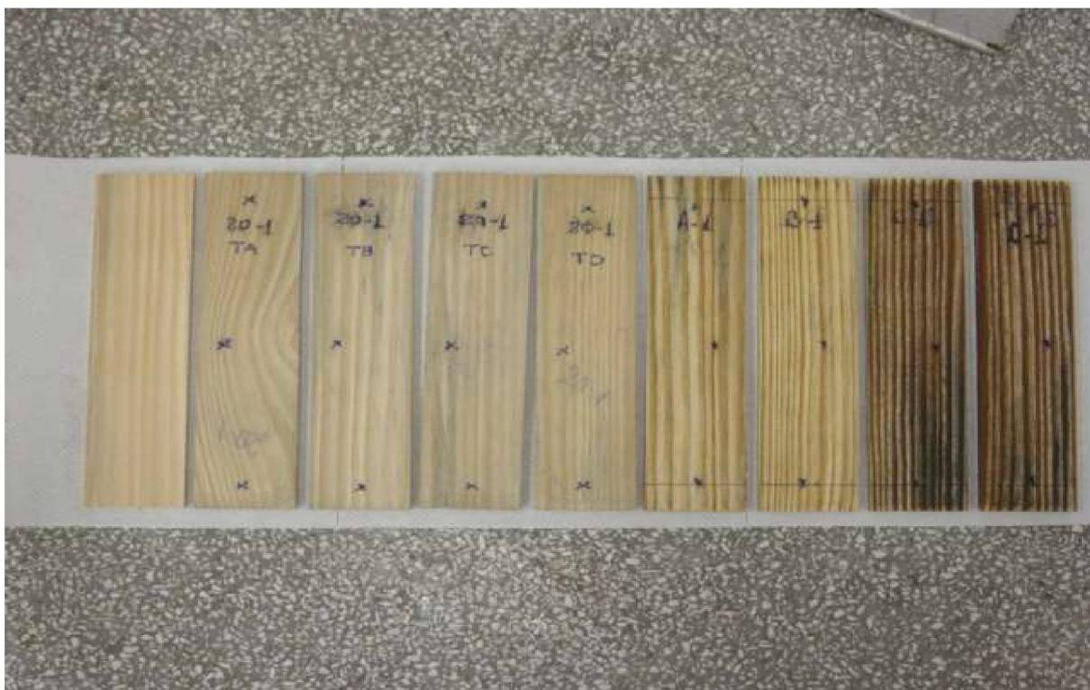
Da esquerda para a direita, a primeira amostra representa a madeira sem tratamento. Na seqüência, TA, TB, TC e TD (Testemunhas secas em estufa) e A, B, C e D, são amostras submetidas ao tratamento térmico com óleo vegetal.
