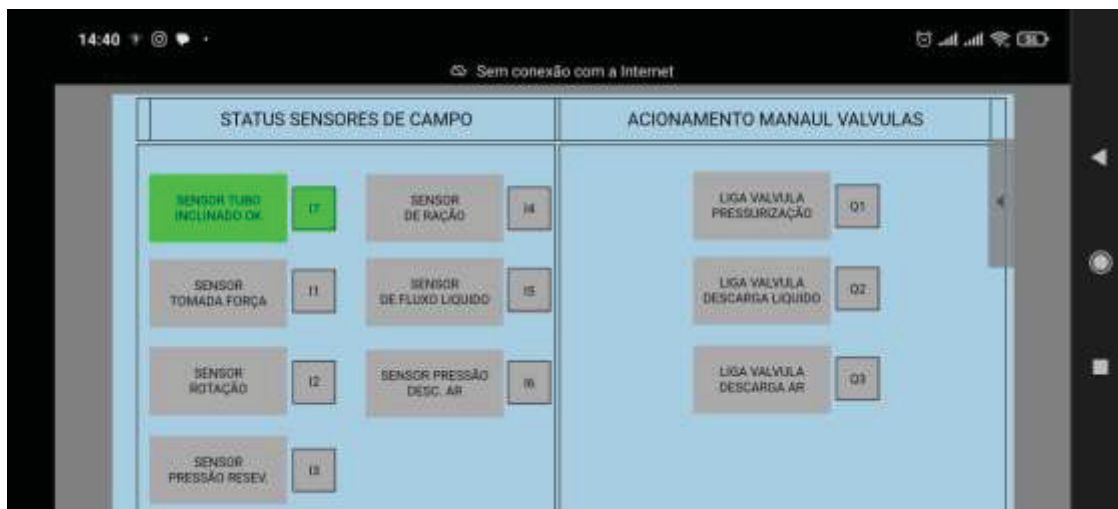
Figura 5: Tela de Status e acionamento manual de válvulas.
