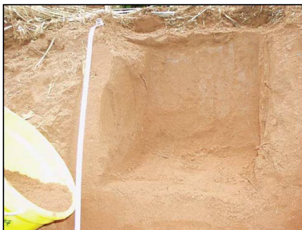
FIGURA 05 – TRINCHEIRA ABERTA PARA A COLETA DO SOLO DA UNIDADE LEA6 - LATOSSOLO VERMELHO ESCURO ÁLICO DA FAZENDA MUTUCA. ARAPOTI PR
