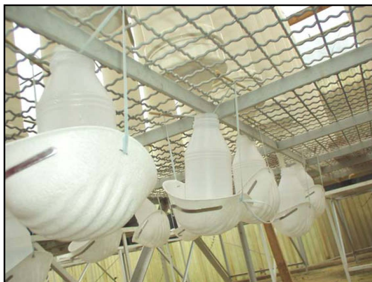
FIGURA 17 – DETALHE DE COMO AS MÁSCARAS DE POEIRA SUSTENTARAM OS FRASCOS DE RECEBIMENTO E ARMAZENAGEM DA SOLUÇÃO PERCOLADA DAS COLUNAS LOCALIZADOS SOB OS FUNÍIS
