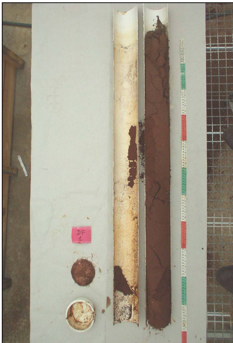
FIGURA 24 – ABERTURA DA COLUNA DE PERCOLAÇÃO PARA AMOSTRAGEM ESTRATIFICADA DE SOLO
