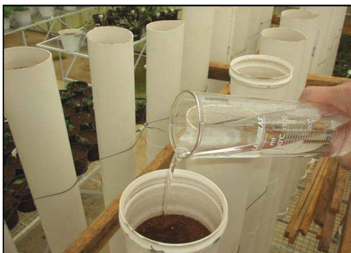
FIGURA 19 – REGA SEMANAL DAS COLUNAS DE SOLO (ARAPOTI PR) PARA SUA PERCOLAÇÃO COM ÁGUA DEIONIZADA
