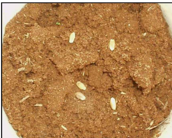
FIGURA 21 – ASPECTO DA SEMEADURA DO TRIGO NAS COLUNAS DE PERCOLAÇÃO ANTES DE SUA COBERTURA COM SOLO
