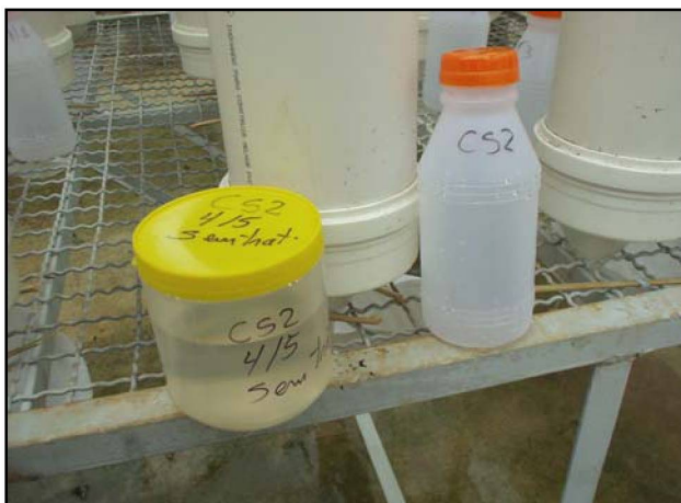
FIGURA 20 – DETALHE DOS FRASCOS UTILIZADOS PARA A COLETA DA SOLUÇÃO PERCOLADA (GARRAFA) E PARA ARMAZENAGEM EM CONGELADOR (POTE)
