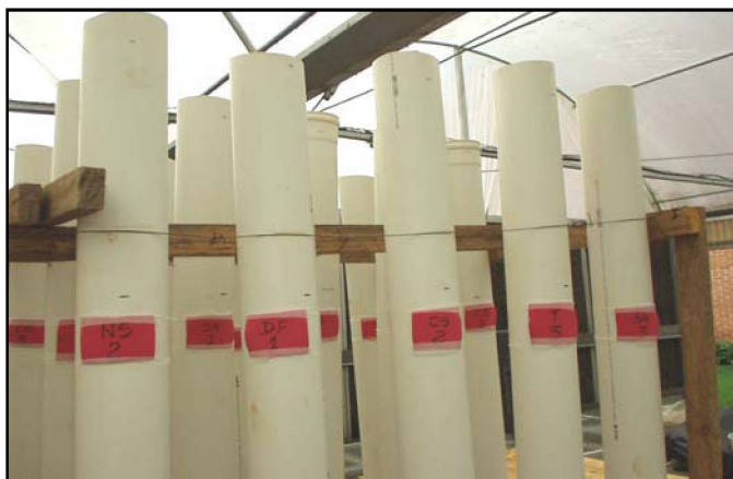
FIGURA 14 – COLUNAS DE PERCOLAÇÃO COM O PERFIL DE SOLO RECONSTRUÍDO E INSTALADO NA CASA DE VEGETAÇÃO
