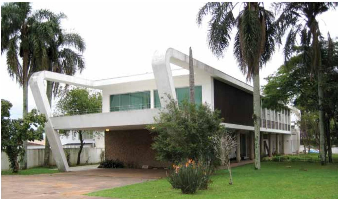
A casa Wolf, localizada em terreno de forte aclive, permitiu que Lolo implantasse, em balanço, a laje da sala de estar. Na casa Slama Kac (1963), o pavimento superior, que contém os quartos, está disposto de forma perpendicular, e em balanço, em relação ao pavimento térreo. Em ambos os casos, as plantas apresentam disposição funcional dos ambientes.
