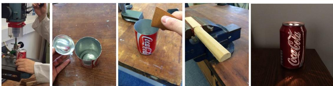
FIGURA 06 – SEQUÊNCIA DE IMAGENS DESCREVEM EXECUÇÃO DE LUMINÁRIA COM LATA DE COCA-COLA.
