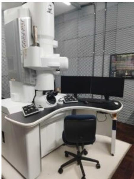
Figura 3.9: Microscópio Eletrônico de Transmissão JEM-F200(HRP) do CME, utilizado para obtenção de imagens dos nanocristais de cuprita. Retirado de [75].
