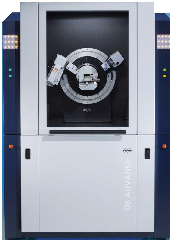
Figura 3.7: Fotografia do equipamento, BRUKER D8 ADVANCE, utilizado nas medidas de DRX. Imagem retirada de [74].
