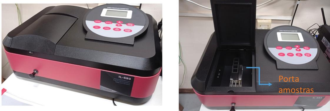
Figura 3.10: Espectrofotômetro utilizado nas medidas de absorbância.
