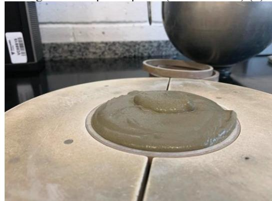
Rasamento do corpo-de-prova – molde (c)
