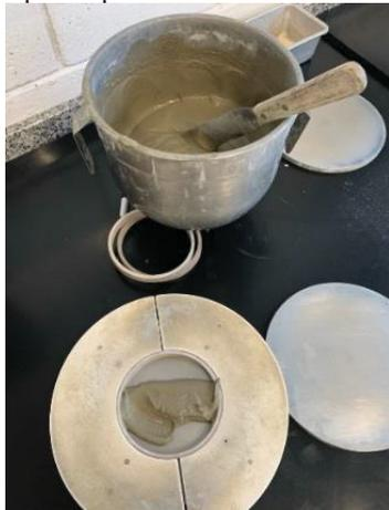
Moldagem do corpo-de-prova (100 x 10 mm) (b)
