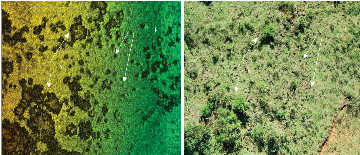
FIGURA 30 – VISUALIZAÇÃO DA FORMAÇÃO ROCHOSA NOS DADOS LiDAR (A) E VISUALIZAÇÃO DA FORMAÇÃO ROCHOSA NA MESMA ÁREA NUMA ORTOFOTO (B).
