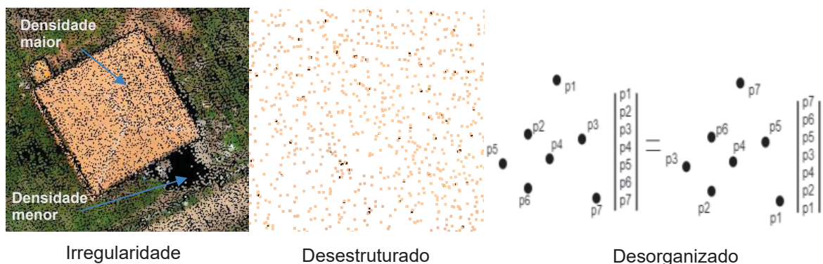
FIGURA 13 – EXEMPLO DE ORGANIZAÇÃO DOS PONTOS DE UMA NUVEM
