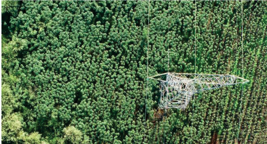
FIGURA 32 - EXEMPLO DE ESTRUTUTURA COM INVASÃO DA VEGETAÇÃO NUMA ORTOFOTO.
