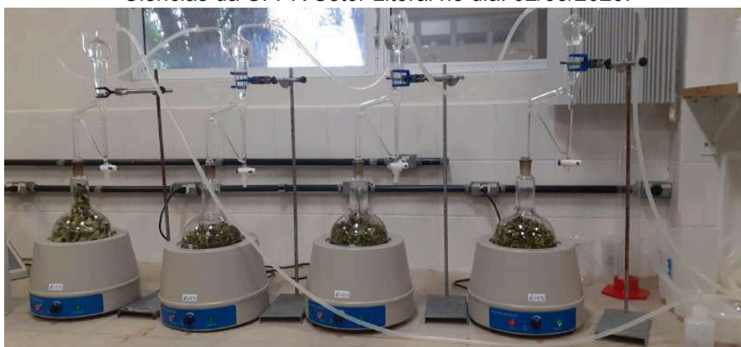
Figuras 3 e 4: Extração de Óleo Essencial de E. paniculata , feita no laboratório de Ciências da UFPR Setor Litoral no dia: 02/03/2020.
