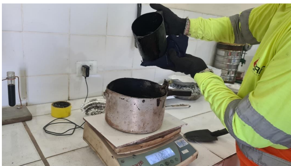
Figura 12 - Adição do CAP nas amostras
