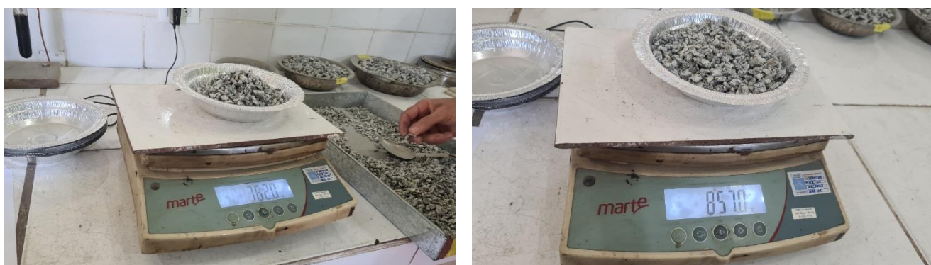
Figura 7 - Brita retida na peneira 4 e brita retida na peneira 8
