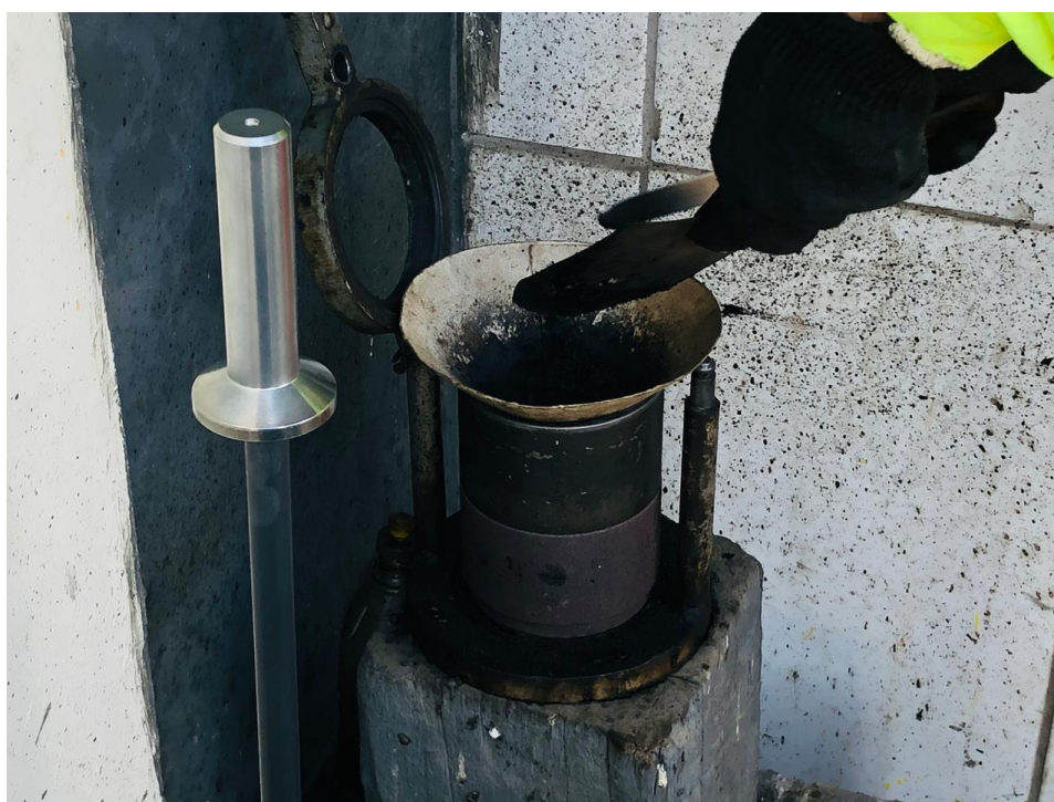
Figura 16 -Amostra sendo colocada na forma
