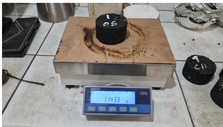
Figura 20 - Massa seca do corpo de prova com RCO
