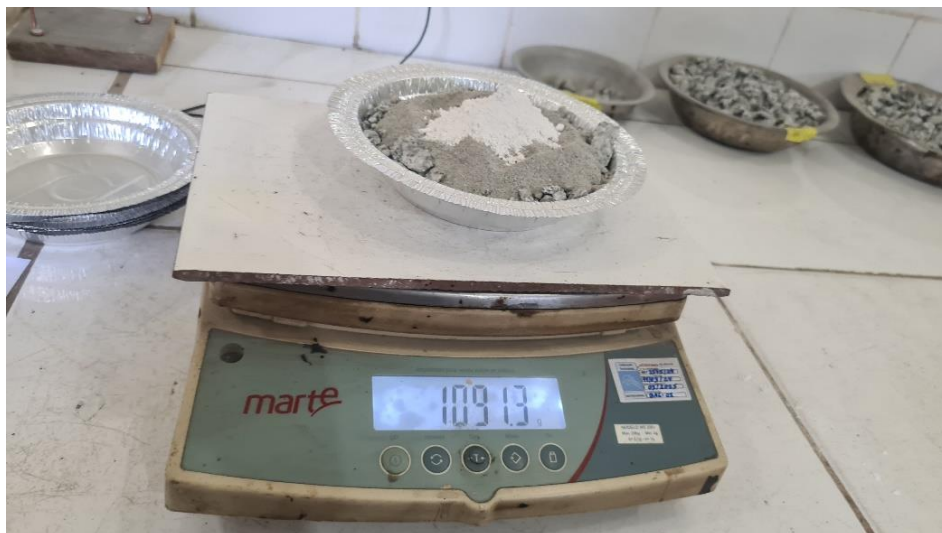
Figura 9 – Adição de 2% de Cal CH 1
