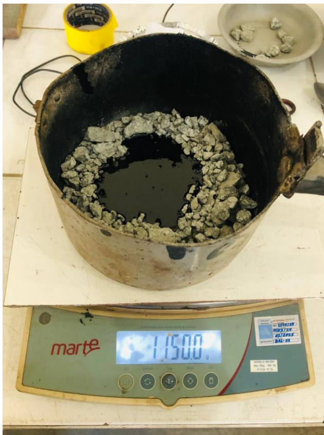
Figura 13 - Amostra com 5,3% de CAP
