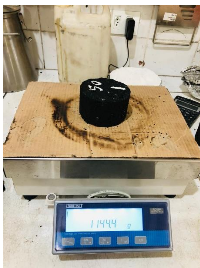
Figura 22 - Massa saturada de corpo de prova
