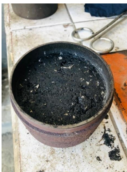
Figura 18 - Corpo de prova após 75 golpes por face
