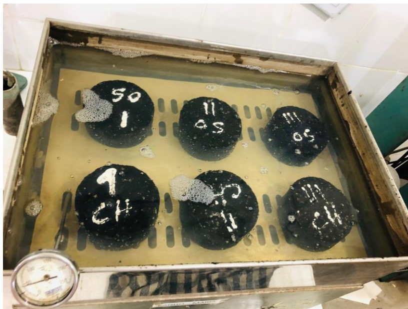
Figura 23 - Corpos de prova em imersão à 60° C.
