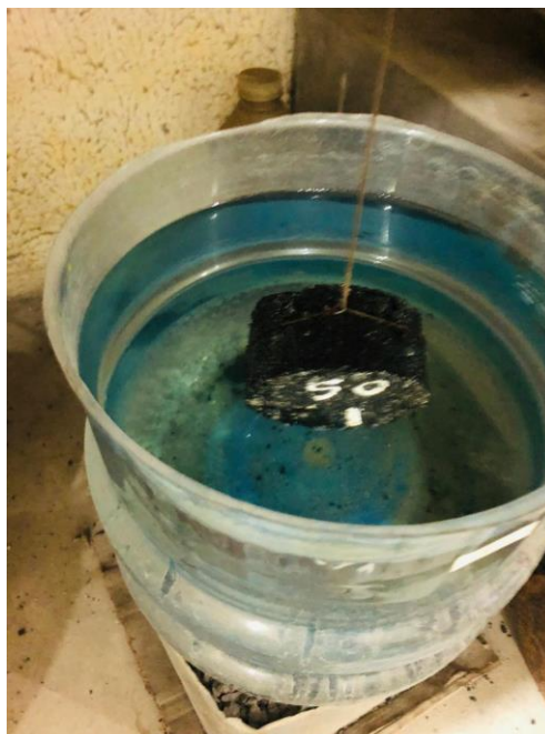
Figura 21 - Massa submersa em água de corpo de prova
