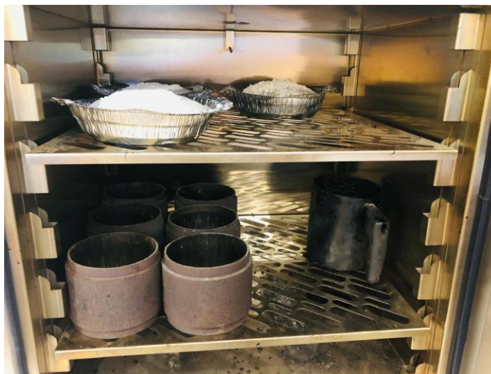
Figura 11 - Amostras no forno industrial a 175° C
