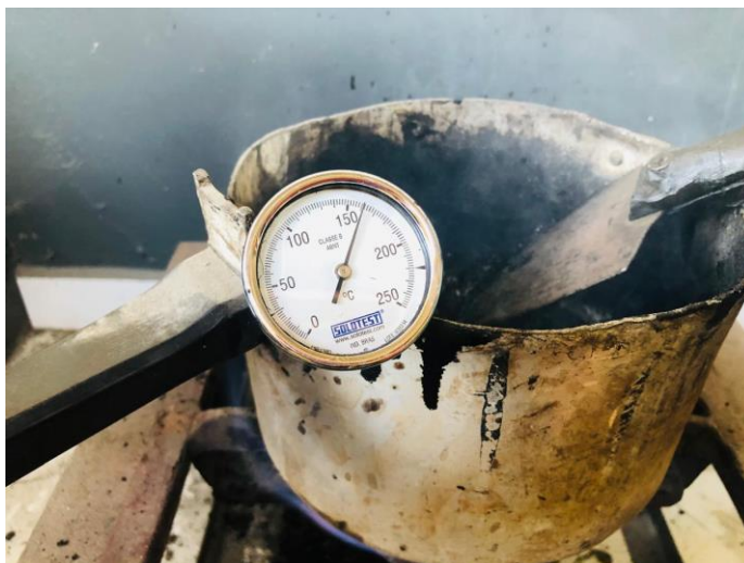
Figura 15 - Mistura à aproximadamente 165° C
