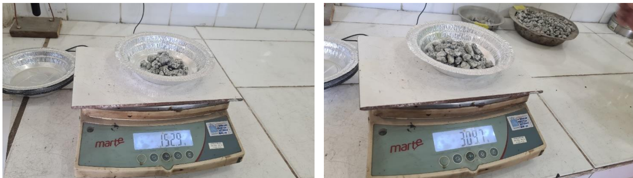
Figura 6 - Brita retida na peneira 1/2 e brita retida na peneira 3/8
