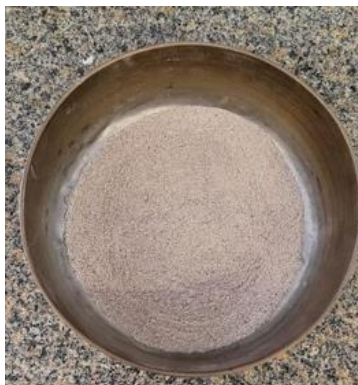
Figura 4 - Resíduo da concha da ostra moído e peneirado
