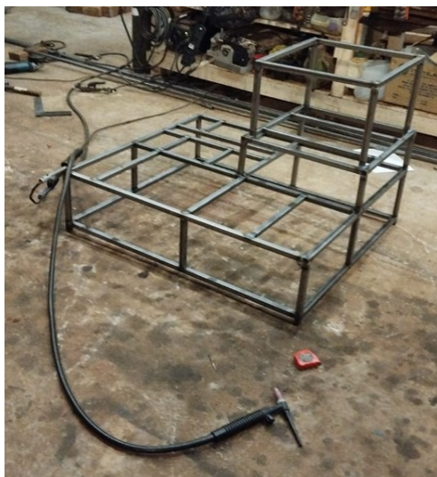
Figura 12 – Procedimentos de construção do chassi do equipamento
