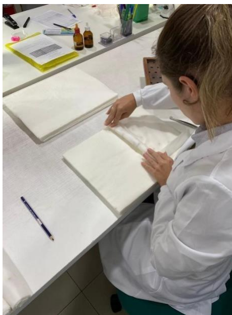
Figura 3 - DOBRADURA SEGUIDA DE ENROLAMENTO DOS RPS
