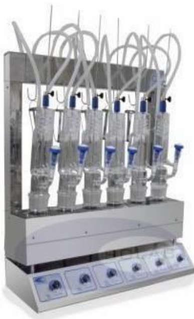
FIGURA 10 - EXTRATOR DE ÓLEOS E GRAXAS ANALÓGICO ATRAVÉS DE SOLVENTE 6 PROVAS (SL-201)
