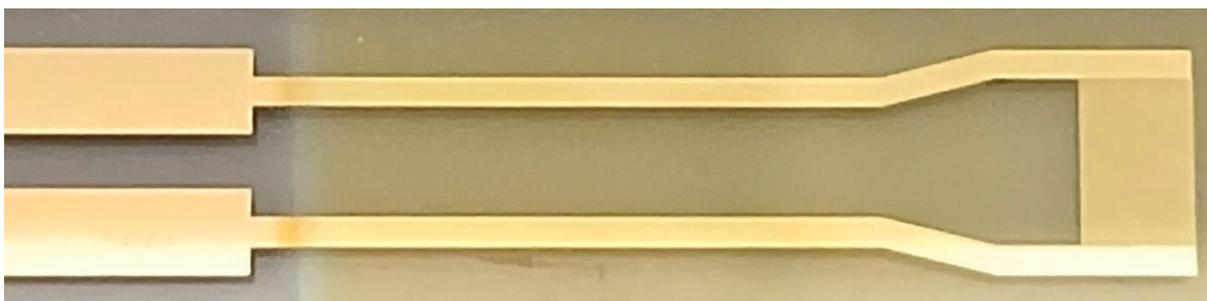
Figura 3.2: Foto do eletrodo interdigitado, composto por 20 nm de cromo e 100 nm de ouro, com o DNTT (em amarelo) depositado sobre ele. Figura da autora.
