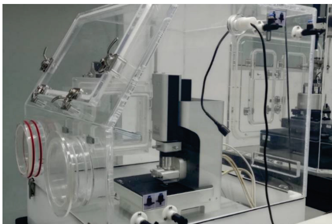
FIGURA 5.3 – EQUIPAMENTO PARK SYSTEMS NX10 UTILIZADO PARA AS MEDIDAS DE MICROSCOPIAS DE FORÇA
