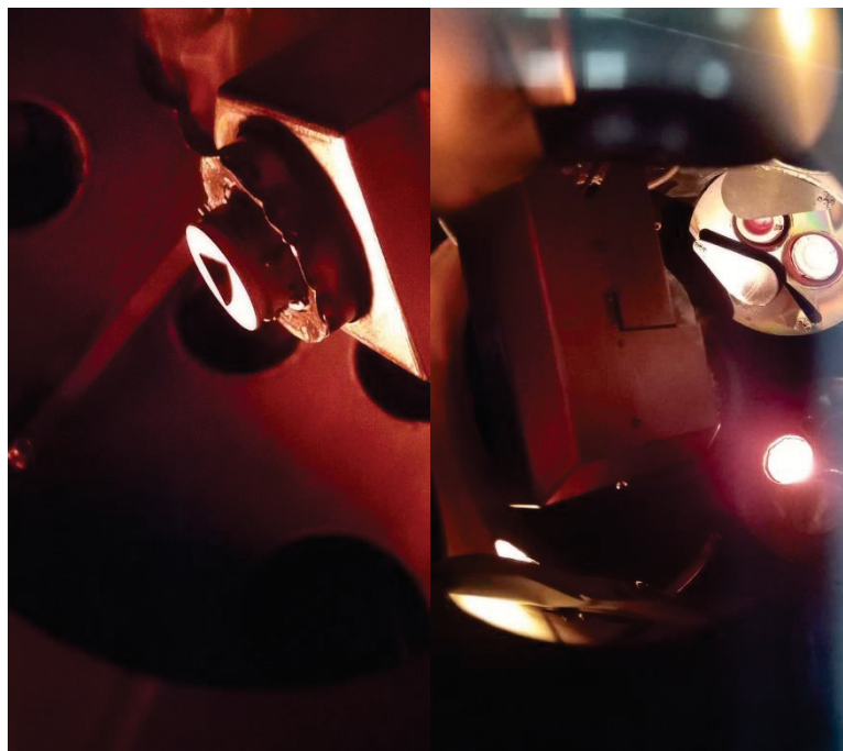
FIGURA 5.2 – SUBSTRATO DE GaAs FIXO NO MOLYBLOCK E AMBOS FIXOS NO BRAÇO MANIPULADOR DE 5 EIXOS DE MOVIMENTO DENTRO DA CÂMARA DE CRESCIMENTOS (ESQUERDA). FACE DO PAINEL DE CÉULAS DO TIPO KNUDSEN (DIREITA) MOSTRANDO A ABERTURA DOS CADINHOS DAS FONTES EM FUNCIONAMENTO COM OS RESPECTIVOS SHUTTERS (FOLHAS DE TÂNTALO) ENTREABERTOS
