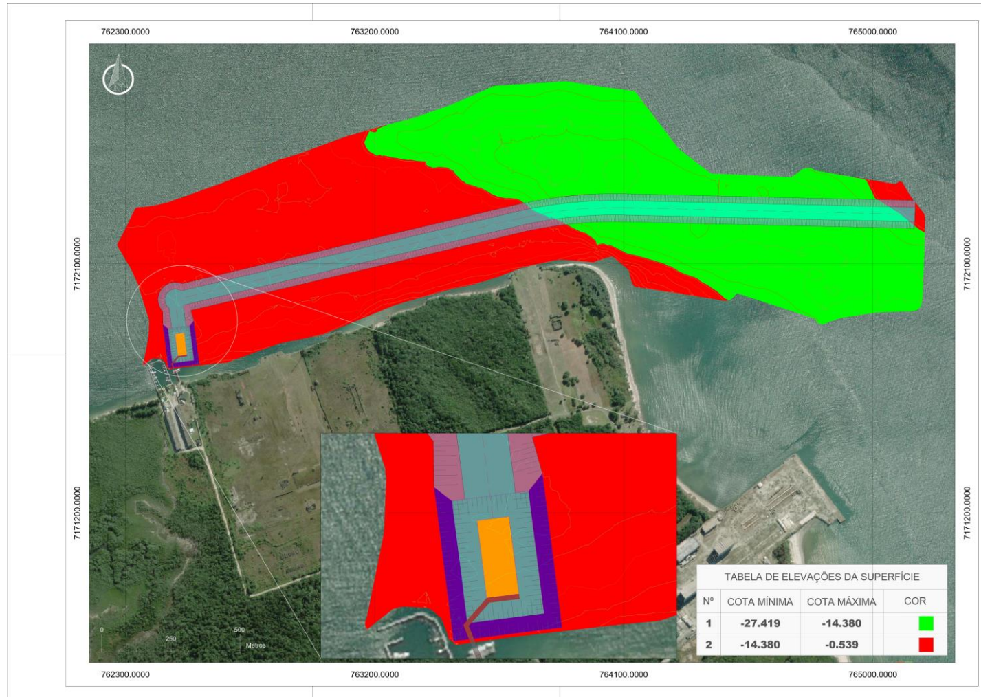
FIGURA 51 – VERIFICAÇÃO DA NECESSIDADE DE DRAGAGEM NA REGIÃO DO DIQUE FLUTUANTE.
