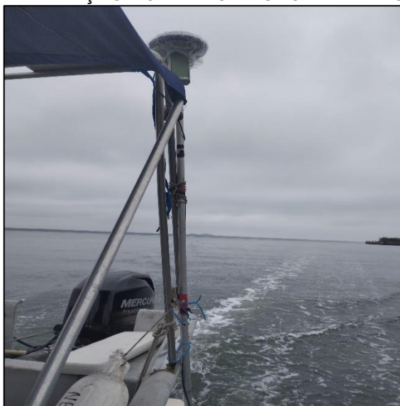
FIGURA 39 - INSTALAÇÃO DO SENSOR ECHOMAP™ E GNSS ROVER.
