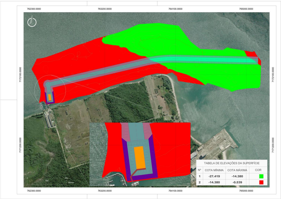
FIGURA 36 – VERIFICAÇÃO DA NECESSIDADE DE DRAGAGEM NA REGIÃO DO DIQUE FLUTUANTE.
