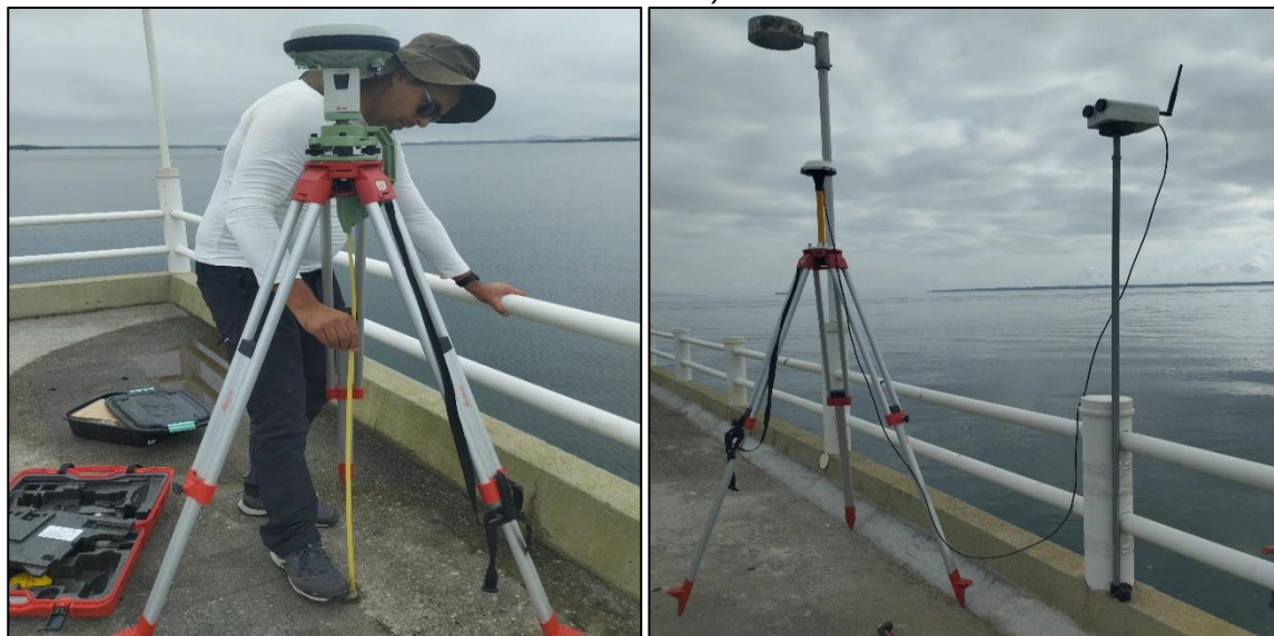
FIGURA 42 - INSTALAÇÃO DA BASE GNSS LEICA GEOSYSTEMS GS15 (À ESQUERDA) E INSTALAÇÃO DA BASE GPS RTK SONTEK E SEU MÓDULO DE ENERGIA E COMUNICAÇÃO (À DIREITA).
