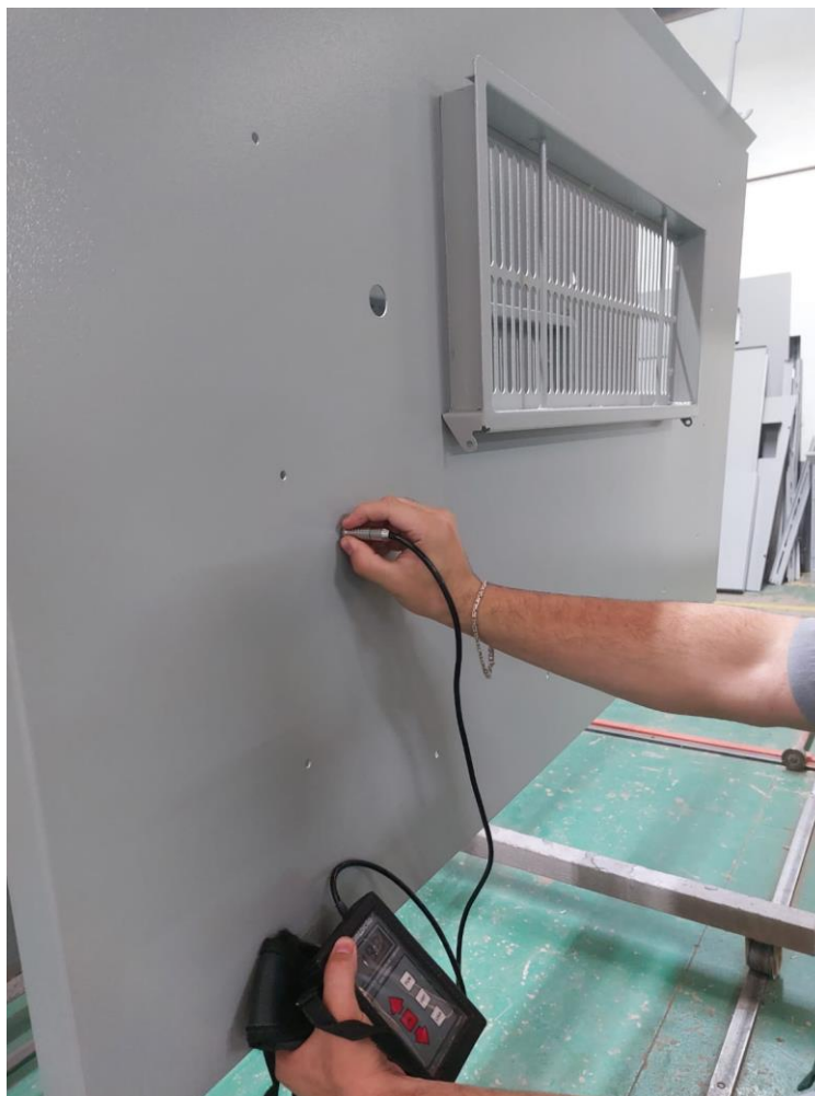
FIGURA 22 – MEDIÇÃO DE CAMADA NO PROCESSO.
