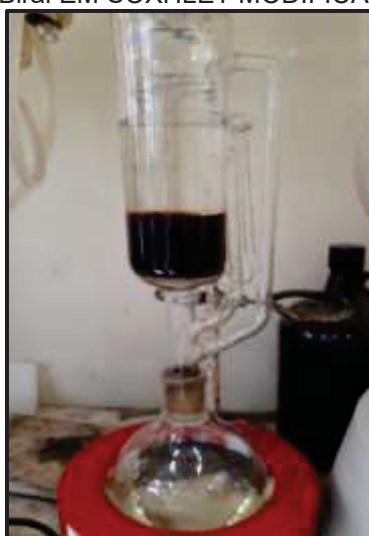
FIGURA 14 - FRACIONAMENTO DO EXTRATO BRUTO DE FOLHAS DE Monteverdia evonymoides (Reissek) Biral EM SOXHLET MODIFICADO
