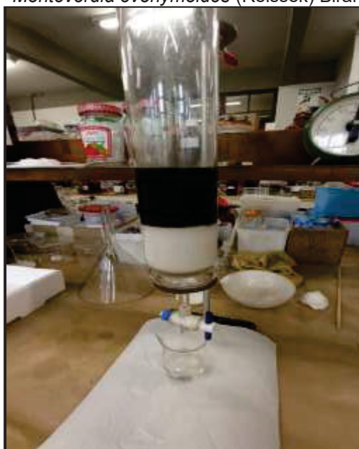
FIGURA 17 - COLUNA CROMATOGRÁFICA PARA ISOLAMENTO DE COMPOSTOS DE Monteverdia evonymoides (Reissek) Biral
