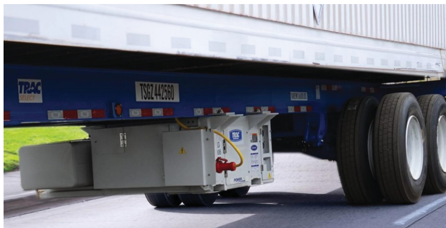
FIGURA 16 - Genset suspenso montado no chassi do caminhão ou contêiner.
