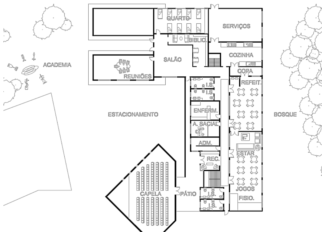
FIGURA 56 – PLANTA DO PAVIMENTO TÉRREO DO LAR
