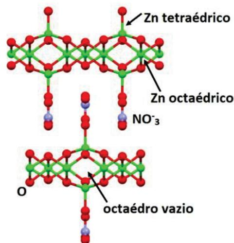
**Figura 10.** Representação da estrutura do sólido HNZ, pertencente a classe dos HSL [83].
