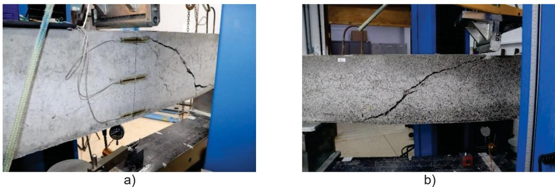
FIGURA 98 – VIGA SFRC0,75-2: A) VISTA DA LATERAL INSTRUMENTADA COM STRAIN GAUGE; B) VISTA DA LATERAL DO ACOMPANHAMENTO POR IMAGEM; C) VISTA GERAL DA VIGA; D) MAPEAMENTO DAS FISSURAS
