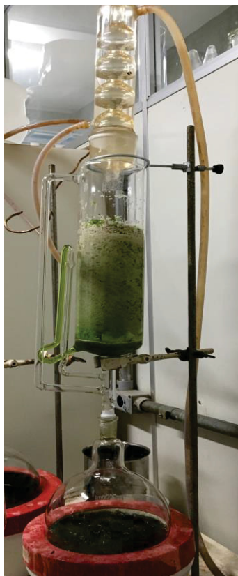
FIGURA 9 – EXTRAÇÃO DAS FOLHAS DE K. laetivirens EM APARELHO DE SOXHLET MODIFICADO
