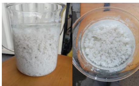
Figura 7 - Formação de lodo no tratamento do mês de Abril/2022.
