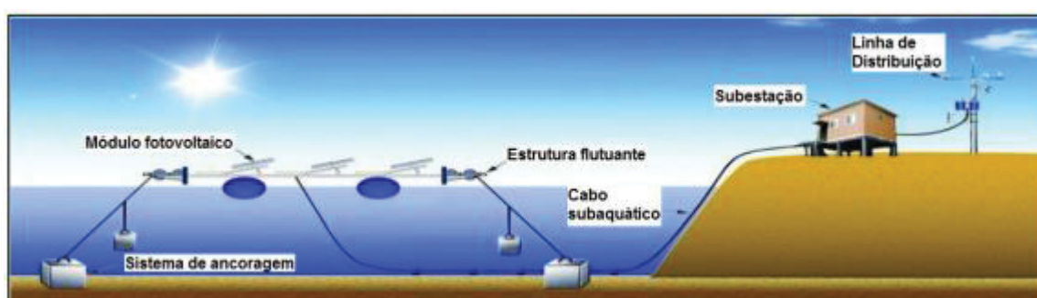
Figura 1 - Esquema geral solar fotovoltaico flutuante. Fonte: EPE, 2020.
