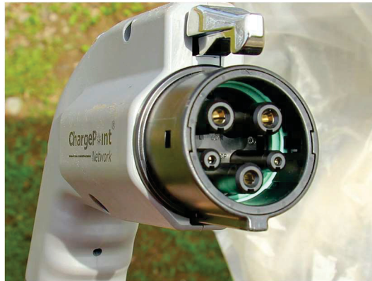
Figura 7: Conector CA Tipo 1 (SAE J1772)
