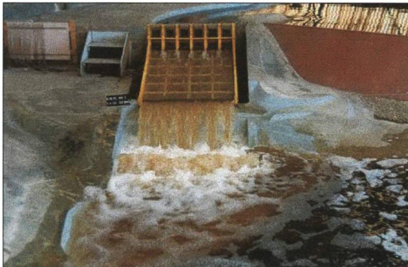
a) modelo 1:100 (Vazão de 15.126 m<sup>3</sup>/s)
