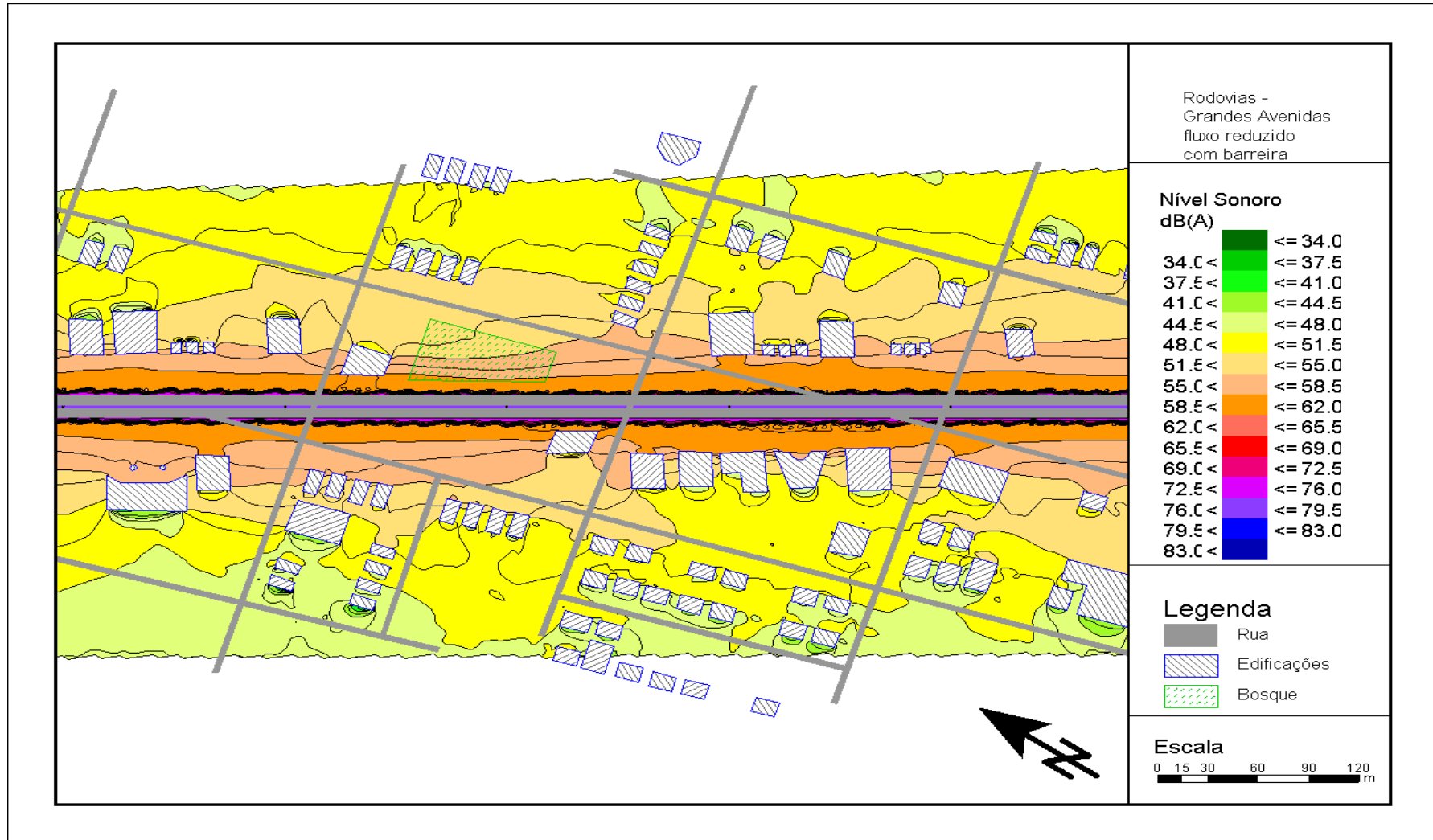
FIGURA 7.12 - MAPA DO RUÍDO EM TORNO DE UMA “RODOVIA-GRANDE AVENIDA” DE CURITIBA COM FLUXO REDUZIDO E BARREIRA – SIMULAÇÃO
