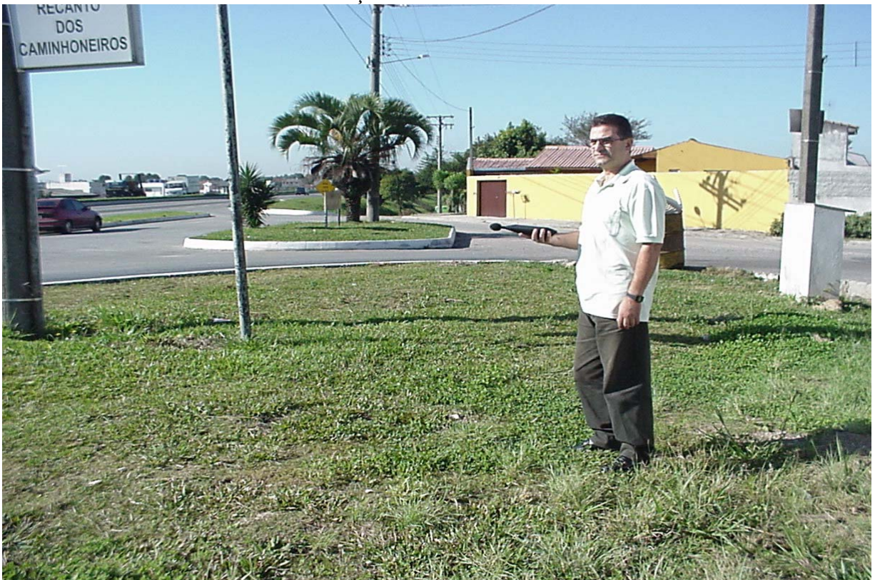
FIGURA 4.3 – DETALHE DA MEDIÇÃO DE EMISSÃO SONORA A 25 METROS
