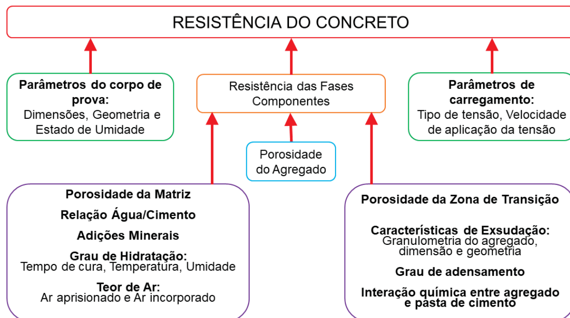
Figura 9 – Interação de fatores que influenciam a resistência do concreto ao longo do tempo.
