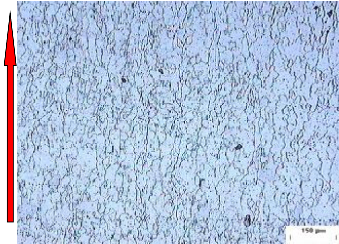
Figura 5.2 – Seção longitudinal da chapa importada.
