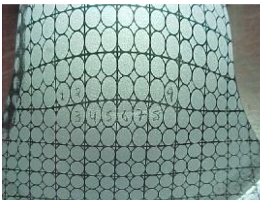
Figura 4.9 - Elipses formadas após a deformação do material.
