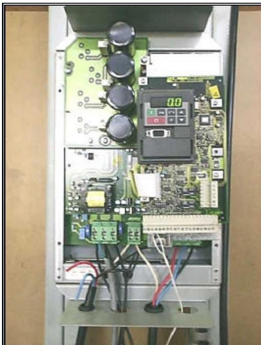
Figura 7: Inversor de Frequência.
