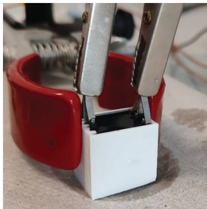
FIGURA 27: Fotografia do invólucro impresso em 3D contendo os eletrodos de aço realizando contato elétrico em paralelo com os terminais do potenciostato. Fonte: A Autora (2023)
