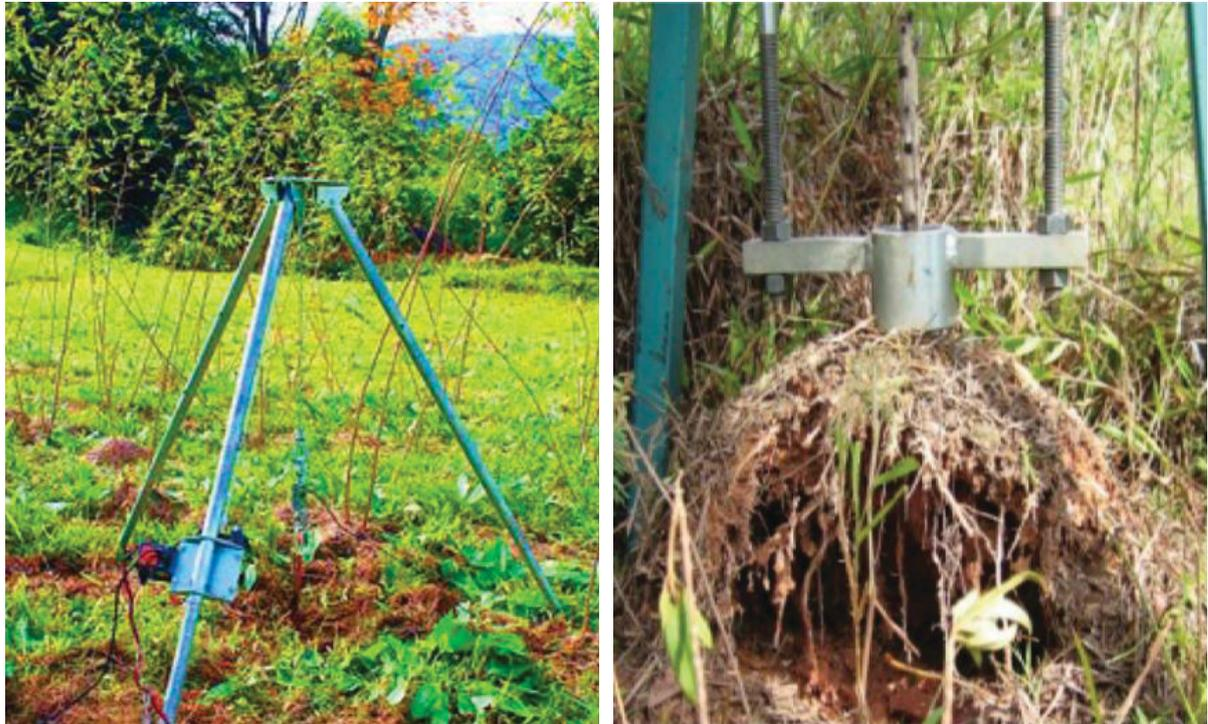
(a) Tripé sendo instalado e acoplado ao caule da planta
