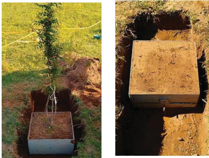
(a) Caixa para ensaio de cisalhamento, em bloco de solo e raiz
