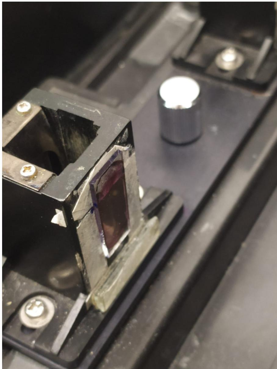
Figura 4.14: Foto do suporte para medida de absorvância dos filmes no equipamento de UV-VIS.
