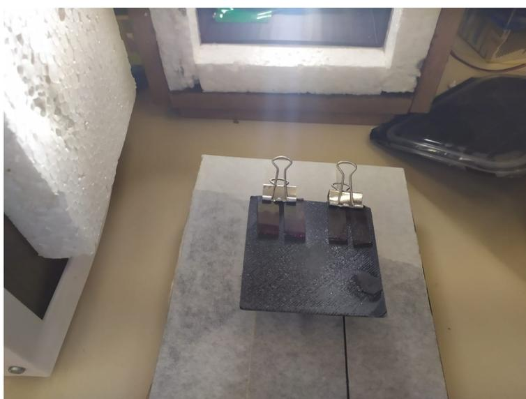
Figura 4.3: Suporte de filmes finos para exposição a condições de degradação
