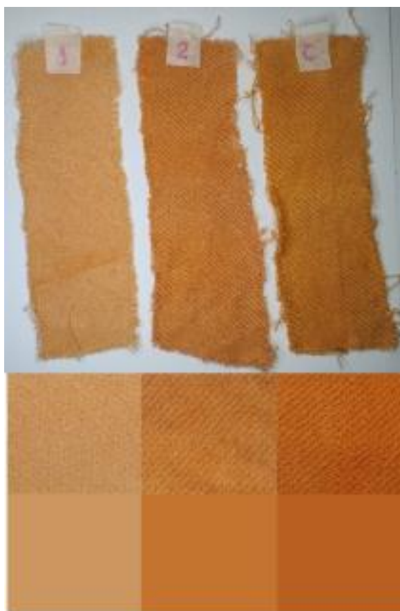
FIGURA 12 – COMPARATIVO DE TONALIDADE APÓS LAVAGENS DE TECIDOS TINGIDOS COM URUCUM NA AUSÊNCIA DE CLORETO DE SÓDIO
