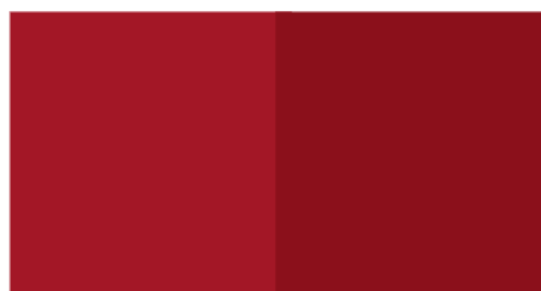
FIGURA 7 – COMPARATIVO DE TONALIDADE DOS TECIDOS TINGIDOS COM CORANTE SINTÉTICO NA AUSÊNCIA (a) E PRESENÇA (b) CLORETO DE SÓDIO
