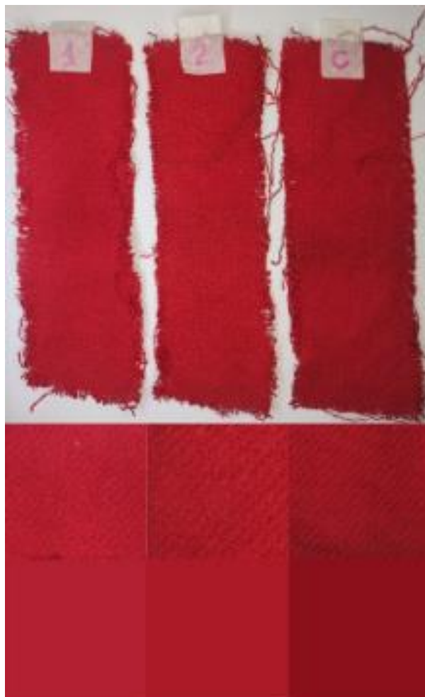
FIGURA 11 – COMPARATIVO DE TONALIDADE APÓS LAVAGENS DE TECIDOS TINGIDOS COM CORANTE SINTÉTICO NA PRESENÇA DE CLORETO DE SÓDIO
