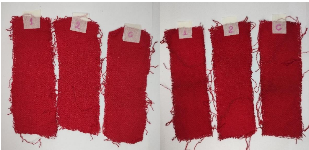
FIGURA 6 – TINTURA DE TECIDO COM CORANTE SINTÉTICO NA AUSÊNCIA E PRESENÇA DE CLORETO DE SÓDIO NO PROCESSO DE TINGIMENTO
