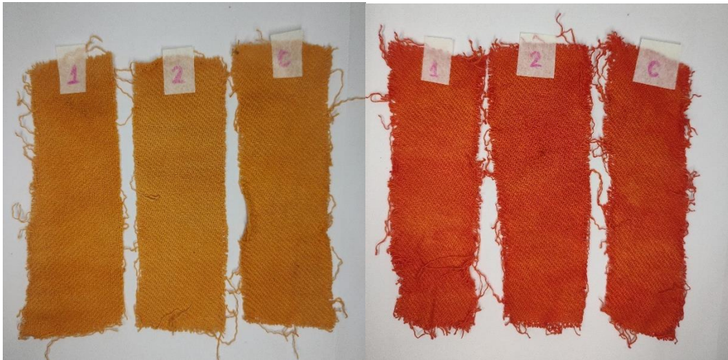
FIGURA 8 – TINTURA DE TECIDO COM URUCUM NA AUSÊNCIA E PRESENÇA DE CLORETO DE SÓDIO NO PROCESSO DE TINGIMENTO
