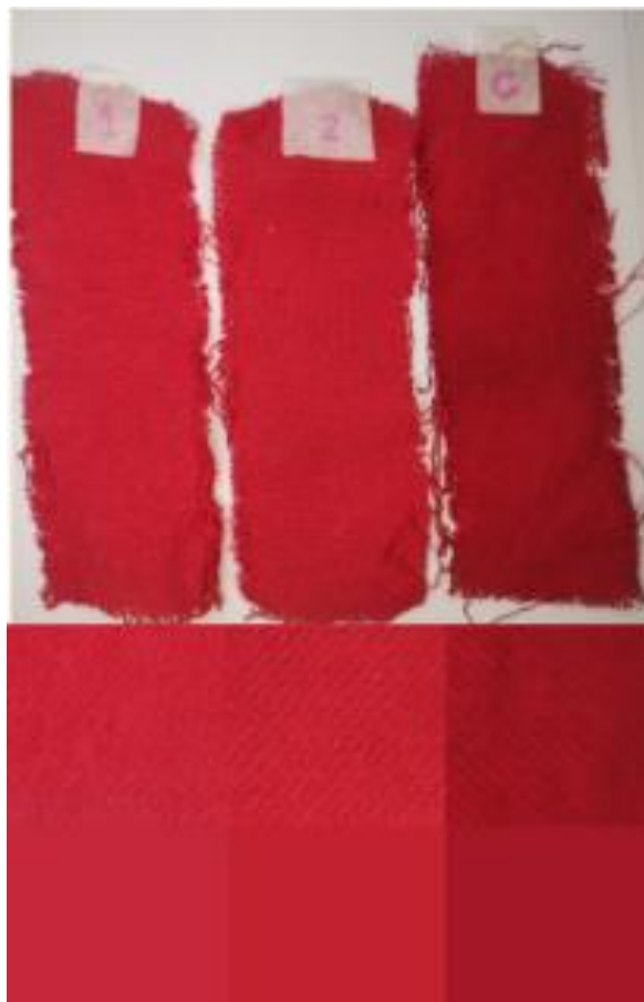
FIGURA 10 – COMPARATIVO DE TONALIDADE APÓS LAVAGENS DE TECIDOS TINGIDOS COM CORANTE SINTÉTICO NA AUSÊNCIA DE CLORETO DE SÓDIO
