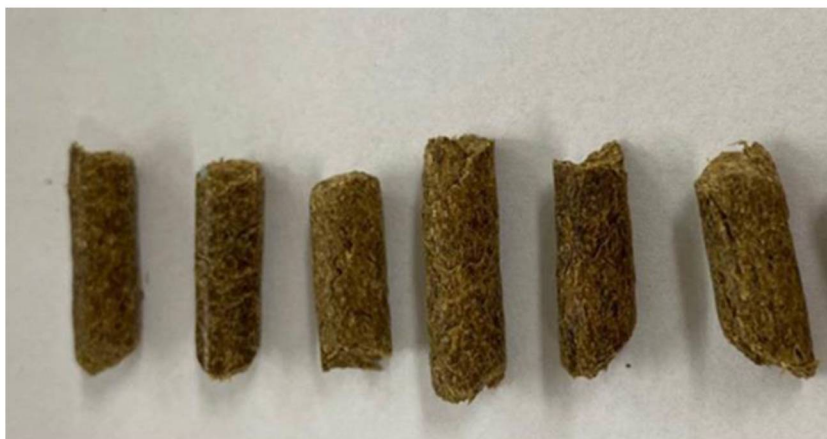
FIGURA 16 - PELLETS COM 60 % CAPIAÇU E 40 % LODO (TRATAMENTO 4)
