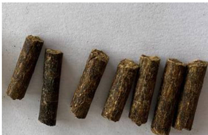
FIGURA 19 - PELLETS COM 100 % LODO (TRATAMENTO 7)
