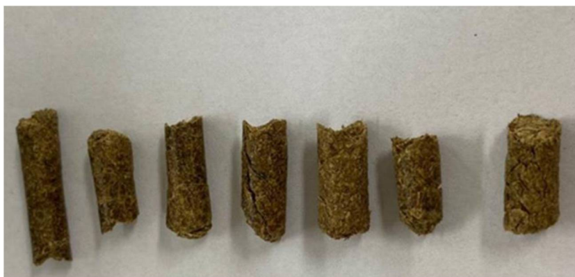
FIGURA 15 - PELLETS COM 80 % CAPIAÇU E 20 % LODO (TRATAMENTO 3)
