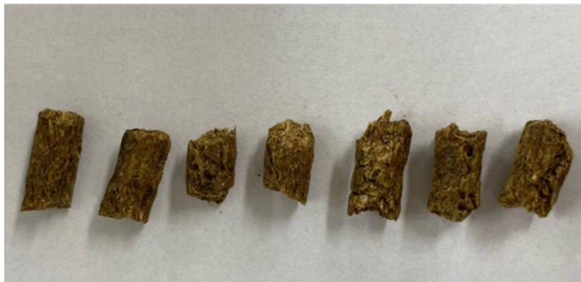
FIGURA 17 - PELLETS COM 40 % CAPIAÇU 60 % LODO (TRATAMENTO 5)
