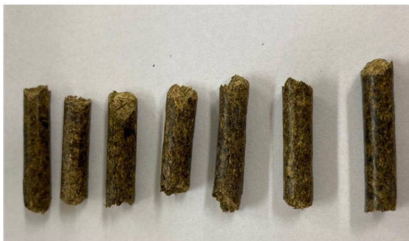
FIGURA 13 - PELLETS COM 100 % CAPIAÇU E 0 % DE LODO (TRATAMENTO 1)
