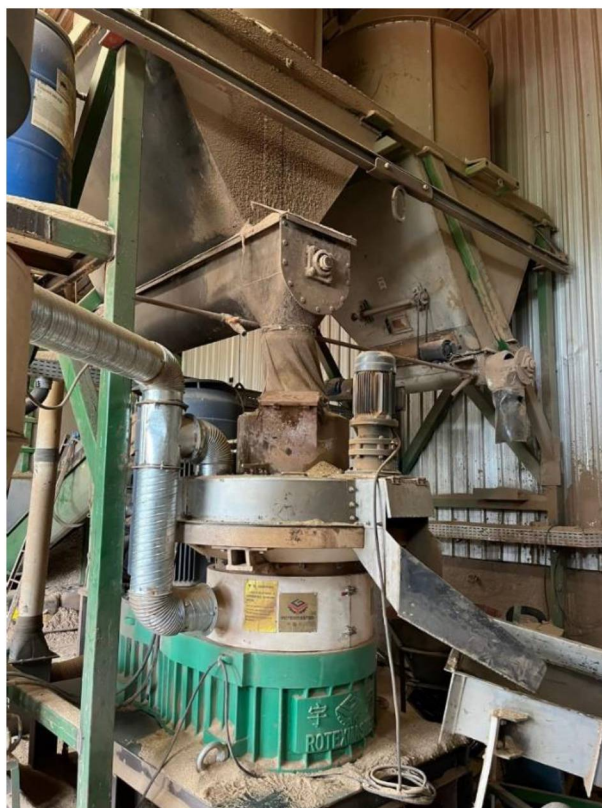
FIGURA 12 - PELETIZADORA UTILIZADA PARA COMPACTAÇÃO DO MATERIAL
