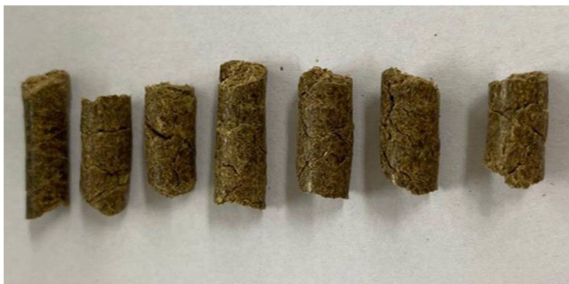
FIGURA 14 - PELLETS COM 90 % CAPIAÇU E 10 % LODO (TRATAMENTO 2)
