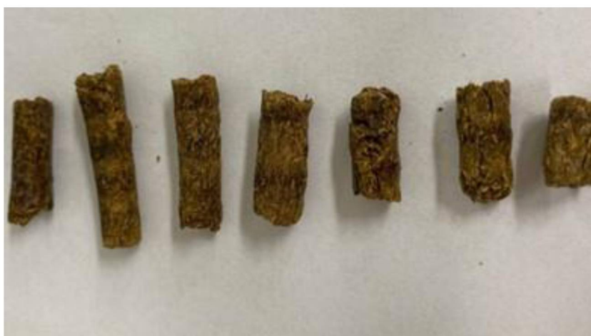
FIGURA 18 - PELLETS COM 20 % CAPIAÇU E 80 % LODO (TRATAMENTO 6)
