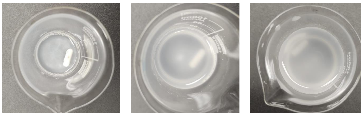
FIGURA 1 – ASPECTO VISUAL DA ETAPA DE DISSOLUÇÃO DA HA EM 25, 50 E 80 mL DE SOLUÇÃO AQUOSA DE pH 8,0.
