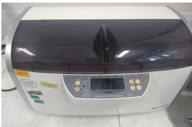
FIGURA 9 – BANHO DE ULTRASSOM UTILIZADO NA EXTRAÇÃO DA PRÓPOLIS
