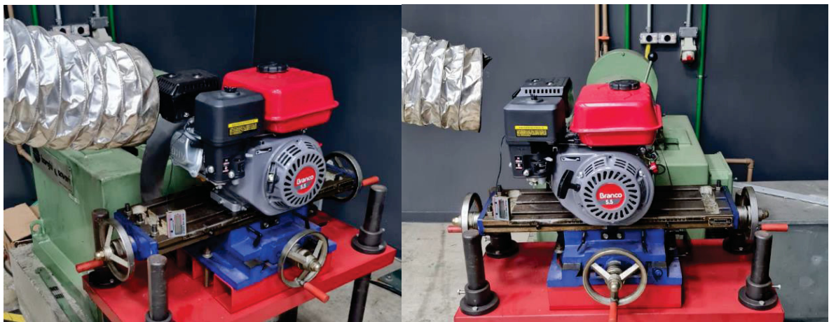
Figura 24 – Motor ciclo Otto B4T-5.5 com filtro de ar e descarga instalados
