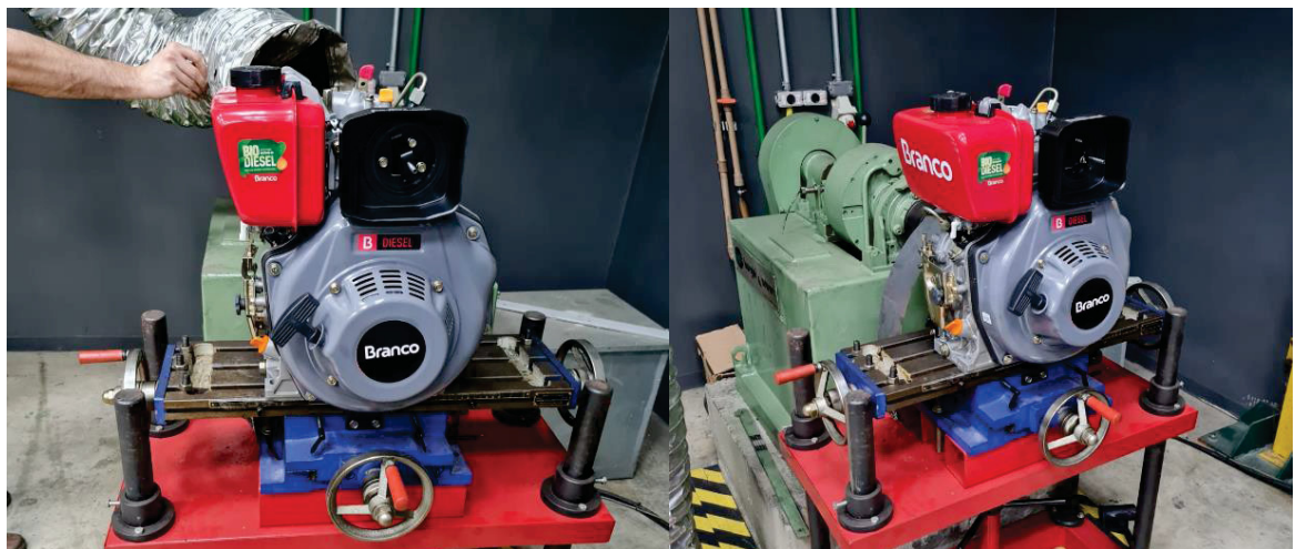
Figura 27 – Motor ciclo Diesel BD-5.0 sem filtro de ar e descarga instalados
