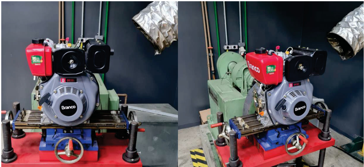
Figura 26 – Motor ciclo Diesel BD-5.0 com filtro de ar e descarga instalados
