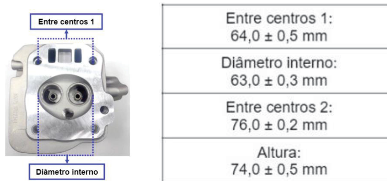
Figura 32 – Cabeçote B4T 5.5H (usinado)
