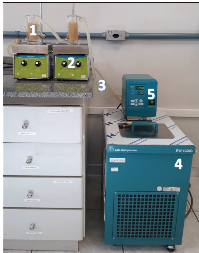
FIGURA 9 – APARATO EXPERIMENTAL PARA A EXTRAÇÃO SÓLIDO-LÍQUIDO UTILIZANDO AGITAÇÃO MAGNÉTICA
