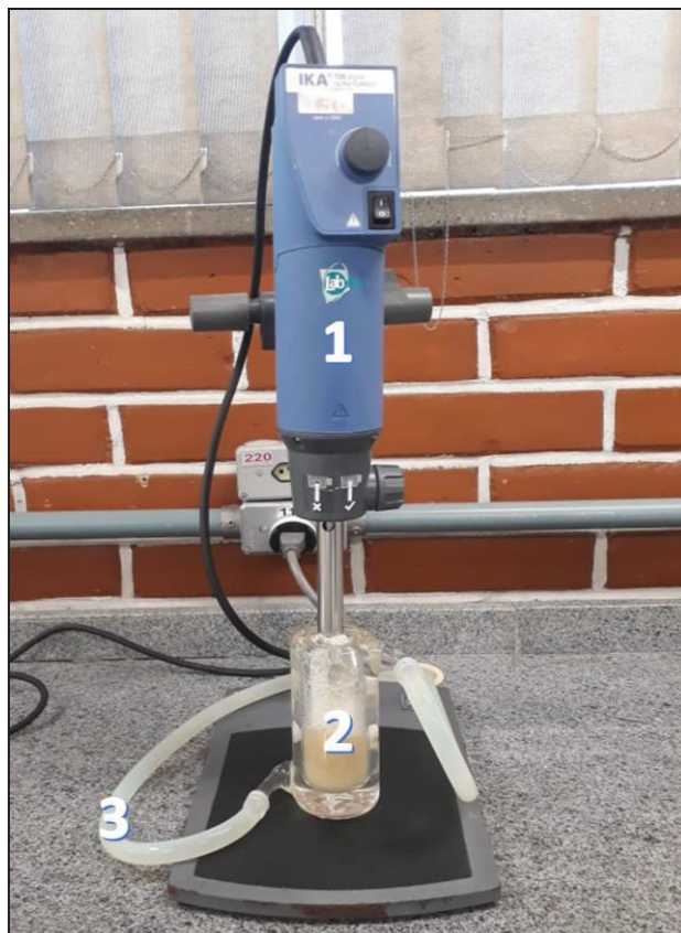
FIGURA 10 – APARATO EXPERIMENTAL PARA A EXTRAÇÃO SÓLIDO-LÍQUIDO UTILIZANDO ULTRA-TURRAX
